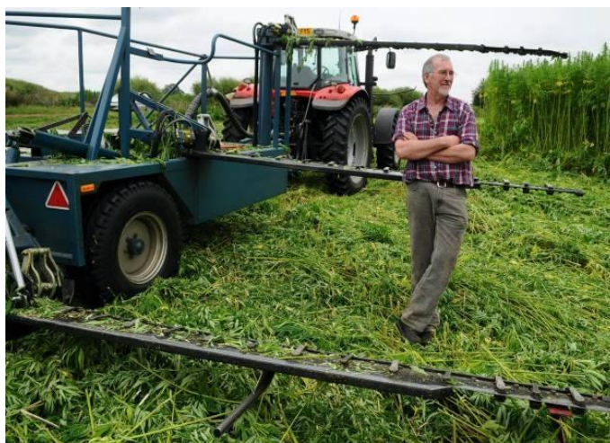
5.5.8.att. Trīs līmeņu kaņepju pļaujmašīnas konstrukcijas paraugs
