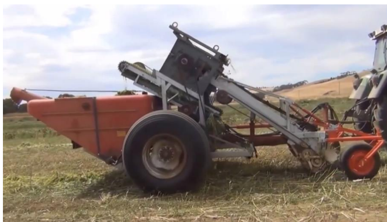
5.5.25.att. Piekabināms kaņepju stiebru savācējs-dekortikators kaņepju šķiedras iegūšanai no zaļiem stiebiem.
