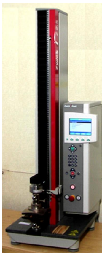
5.4.2. att. Materiālu testēšanas iekārta Zwick C-FR2.5TN.D09
