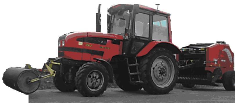
5.5.28.att. Kaņepju vāla blīvēšanas ierīce agregātā ar rituļu savācējpresi.
