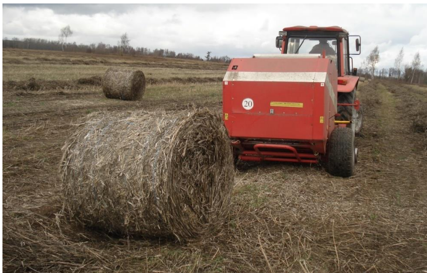
5.5.27.att. Kaņepju stiebru presēšana ar valču tipa rituļu presi Piedrujas pagastā.
