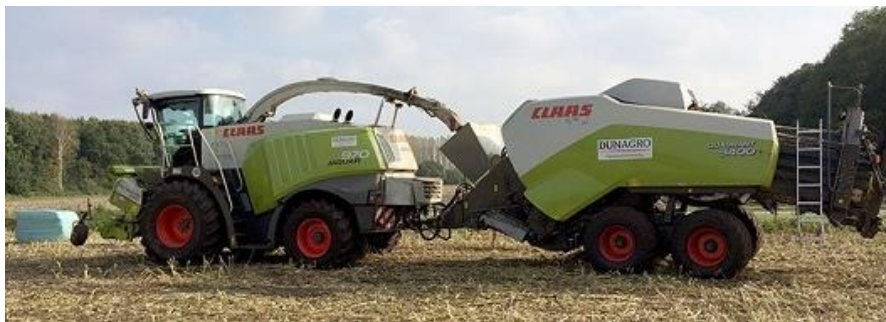
5.5.19.att. Firmas Dunagro kombinēts agregāts (pašgājēja smalcinātāja un ķīpu savācējpreses kombinācija).
