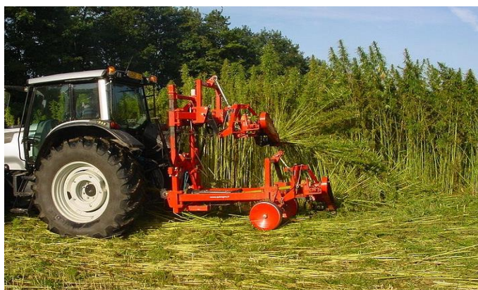
5.5.7.att. Divu līmeņu kaņepju pļaujmašīnas konstrukcijas eksperimentāls variants
