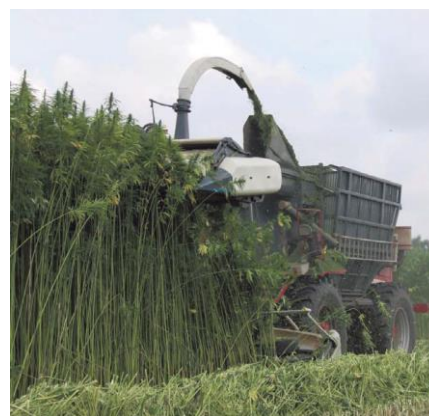
5.5.15.att. Pirmās paaudzes Dunagro kaņepju novākšanas agregāts
