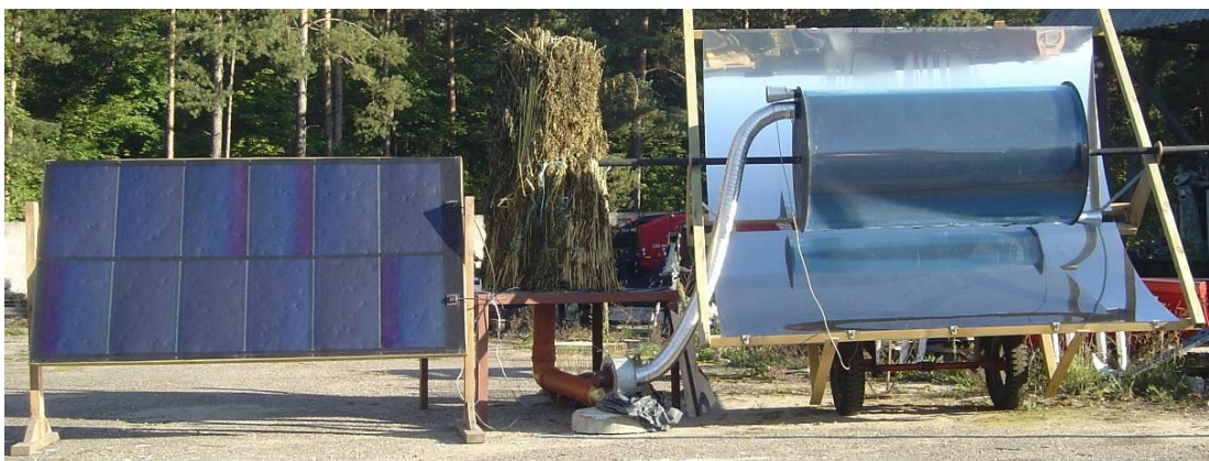
5.5.33.att. Ierīces stiebraugu kaltēšanai ar saules enerģiju eksperimentālais prototips
