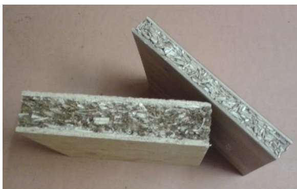
5.5.18.att. Kaņepju celtniecības-izolācijas plāksņu eksperimentālie paraugi
