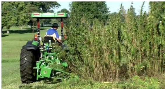
5.5.13.att. Kaņepju pļaušana ar John Deere segmentu-pirkstu pļaujmašīnu
