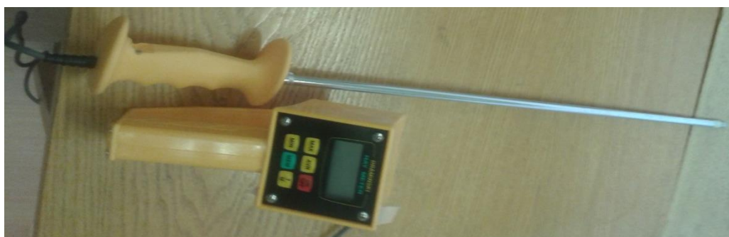
5.5.30.att. Elektroniskais rituļu mitruma mērītājs (modelis Draminski).
