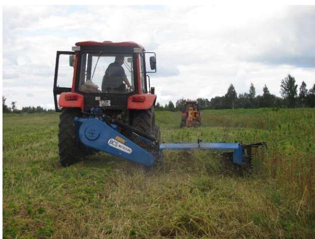
5.5.22.att. Zāles plaujmašīna- placinātājs BCS Rotex R5 izmēģinājumos kaņepju stiebru placināšanā.
