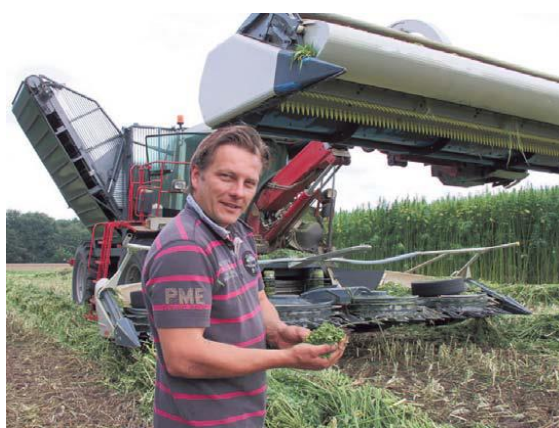
5.5.15.att. Pirmās paaudzes Dunagro kaņepju novākšanas agregāts
