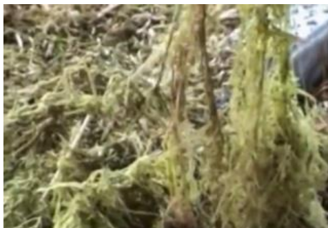
5.5.26.att. Ar dekortikāciju iegūta kaņepju šķiedra (pēc iziešanas no mašīnas).
