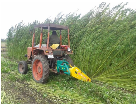
5.5.12.att. Pļaujmašīna KD-210 pļaušanas procesā 2015.gadā (skats no aizmugures)
