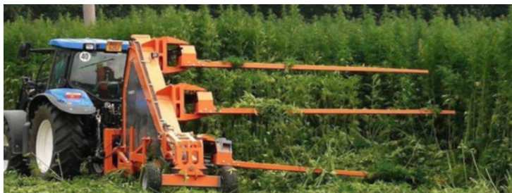
5.5.3. att. Trīs līmeņa kaņepju pļaujmašīna Clipper 4.3 MMH (Tebeco, Čehijas Republika)
