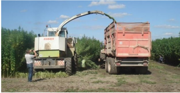
5.5.15. att. Kaņepju stiebru novākšana ar kukurūzas novākšanas kombainu Jaguar
