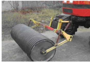
5.5.30. att. Kaņepju stiebru vāla blīvējošā veltņa konstrukcija.
