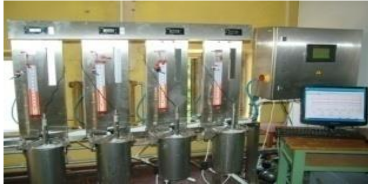
4.2.1. att. Bioreaktoru bloks biogāzes potenciāla pētīšanai
