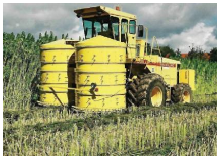
5.5.2. att. Bluecherh 02 agregāts uzstādīts New Holland 1905 pašgājējam
