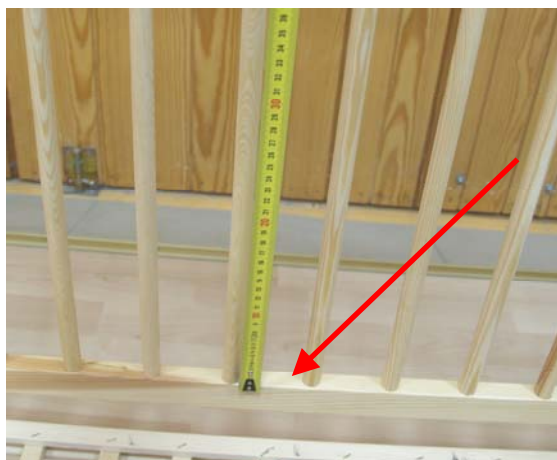
2.7. att. Bērnu gultiņas „DOMINIK MINI” sāns. Bērnam iespējams uzkāpt uz gultiņas sāna apakšējās horizontālās brusiņas.
