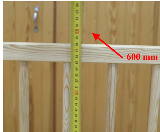
2.18. att. Bērnu gultiņa „RADEK VII”. . Attālums no gultiņas sāna apakšējās horizontālās brusiņas līdz sāna augšējai malai mazāks par 600 mm.
