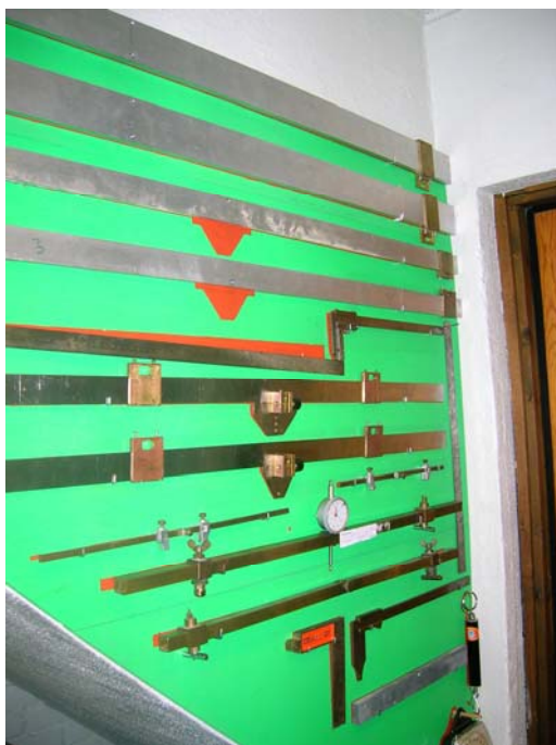
1.5. att. Lokālā lieces elastības moduļa noteikšanas palīgaprīkojums.
