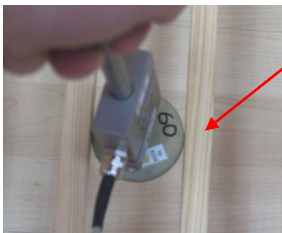
2.9. att. Bērnu gultiņas „DOMINIK MINI”. Starp gultiņas pamatnes blakus esošām listēm iet cauri mērišanas konuss 60 mm.
