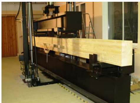
6.2. att. Līmēto konstrukcijas kokmateriālu pārbaude saskaņā ar LVS EN 408 nosakot lieces stiprību un lieces elastības moduli.
