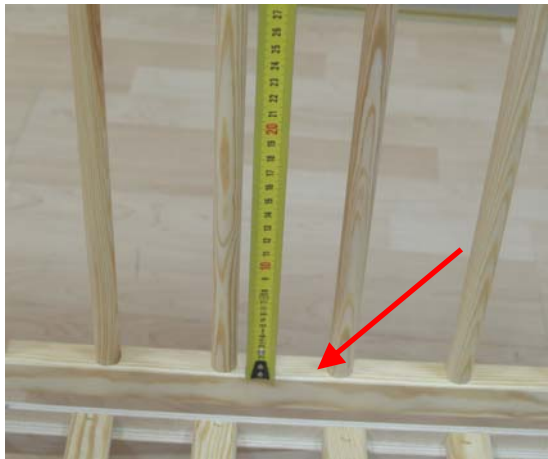
2.17. att. Bērnu gultiņa „RADEK VII”. Bērnām iespējams uzkāpt uz gultiņas sāna apakšējās horizontālās brusiņas.
