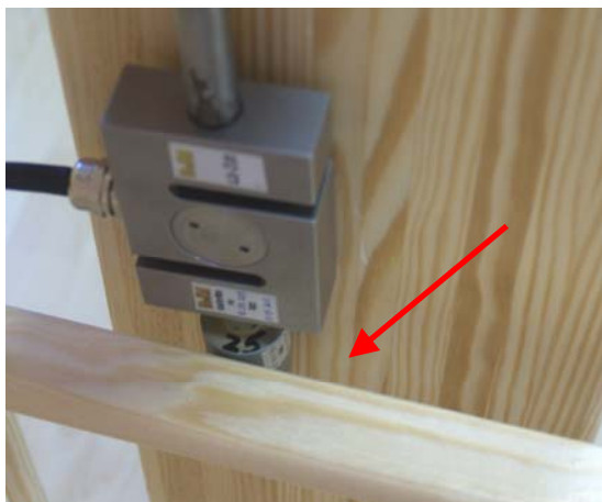
2.19. att. Bērnu gultiņa „RADEK VII”. Atvērums starp gultiņas pamatni un galu iet cauri 25 mm mērīšanas konuss, ko nepieļauj LVS EN 716-1:2008 drošības prasības.
