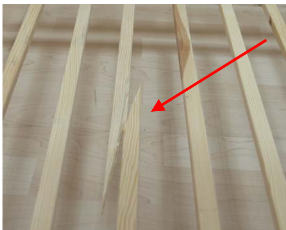
2.11. att. Bērnu gultiņas „DOMINIK MINI”. Gultiņas pamatnes testēšanas laikā salūza gultiņas pamatnes līste.
