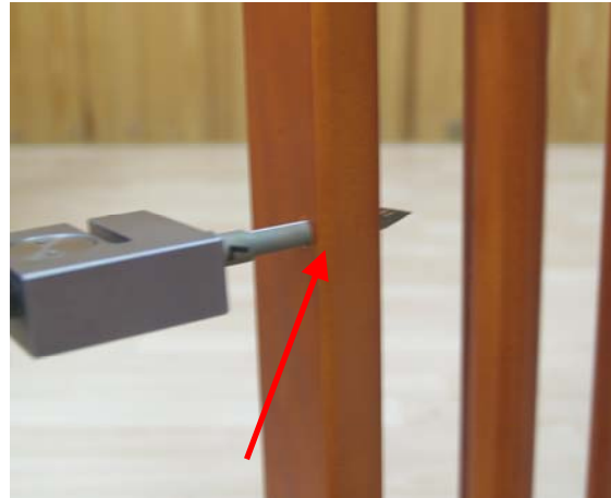
2.25. att. Bērnu šūpuļgultiņa „RADEK V”. Montāžas caurumi lielāki par 7 mm.
