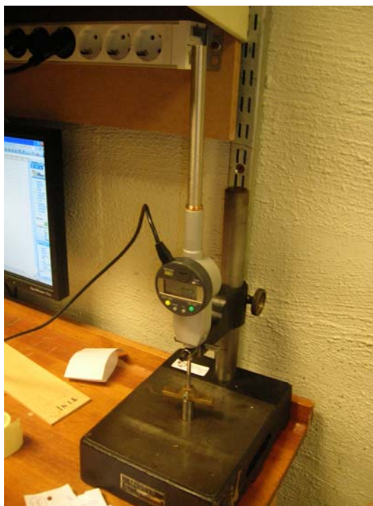
1.8. att. Lineārā pārvietojuma kalibrēšanas palīgaprikojums.
