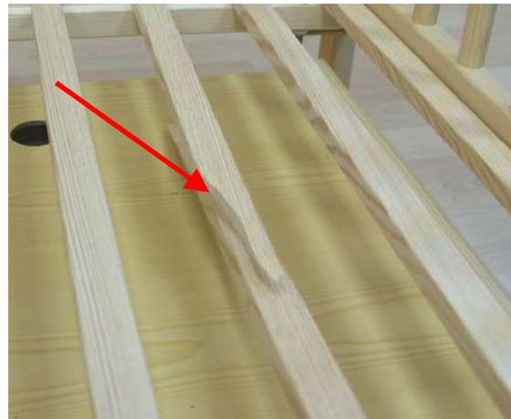
2.14. att. Bērnu gultiņa „KUBA II”. Gultiņas pamatnes trieciena testa izpildes laikā salūza gultiņas pamatnes līste.
