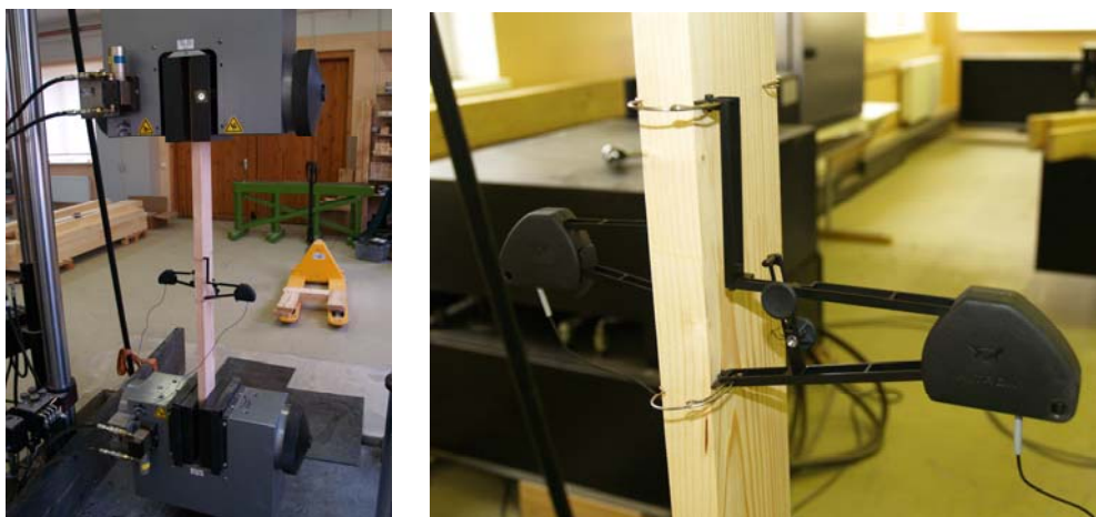
5.8. att. Stiepes stiprības un stiepes elastības moduļa noteikšanas aprīkojums.
