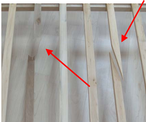
2.4. att. Bērnu gultiņa „BOBAS”. Gultiņas pamatnes testēšanas laikā salūza divas gultiņas pamatnes līstes. Viena no salūzušajām gultiņas pamatnes līstēm bija ielūzusi jau pirms testēšanas.
