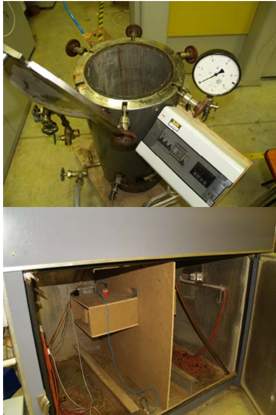
5.5. att. Atslāņošanās testa spiediena kamera un žāvēšanas tunelis
