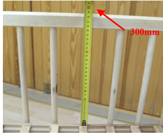
2.3. att. Bērnu gultiņa „BOBAS”. Gultiņas pamatnei un sāniem/galiem atrodies augstākajā pozīcijā attālums starp gultiņas pamatni un sāna augšējo malu mazāks par 300 mm, ko nepieļauj standarta LVS EN 716-1:2008 drošības prasības.
