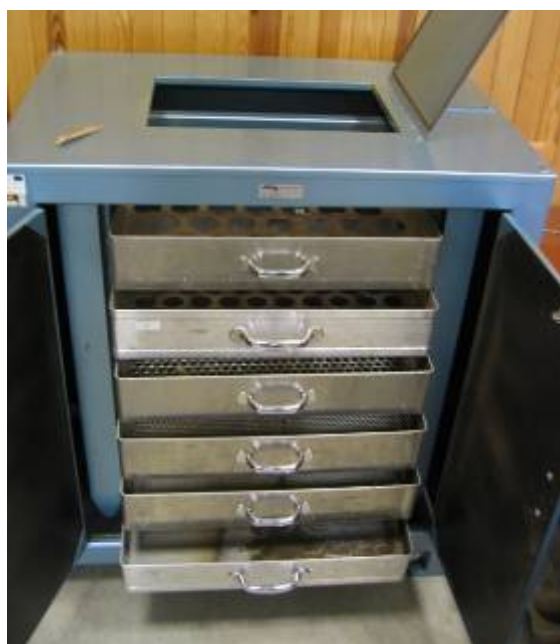
3.7. att. Oscilācijas iekārta ar sieta komplektu virs 3,15mm acīm.
