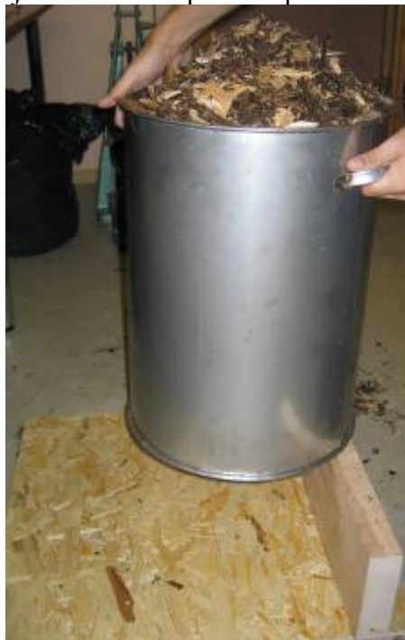
3.5. att. Konteintera satura sablīvēšana ar konteintera nomešanu no noteikta augstuma.
