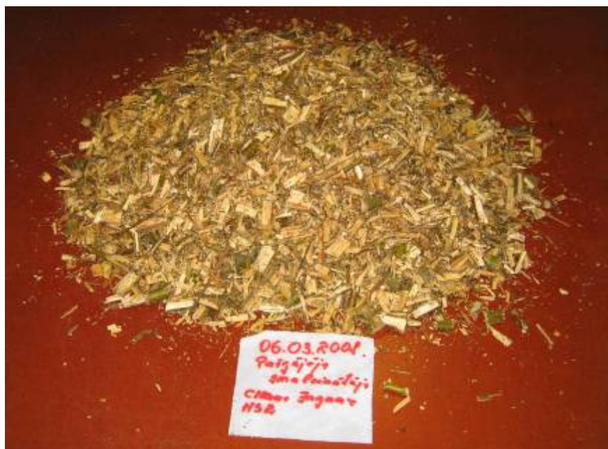
3. att. Kārķu šķeldas iegūtas ar šķeldotāju-pašgājēju CLASS JAGUAR HS2.
