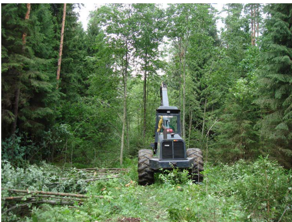
4. att. Grāvju apauguma novākšana ar Bracke C16a.
