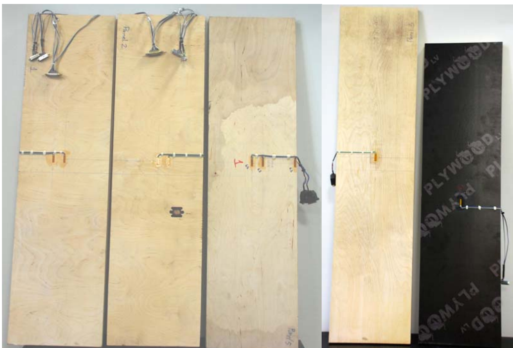
3.18 att. Tenzorezistori izvietoti uz finiera „sendvič” un references plātņu paraugiem
